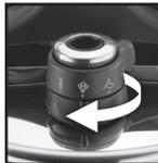
Prima di iniziare la cottura verificate che il dispositivo di blocco del manico a leva LEVERBLOCK® sia abbassato. (fig. 11)
